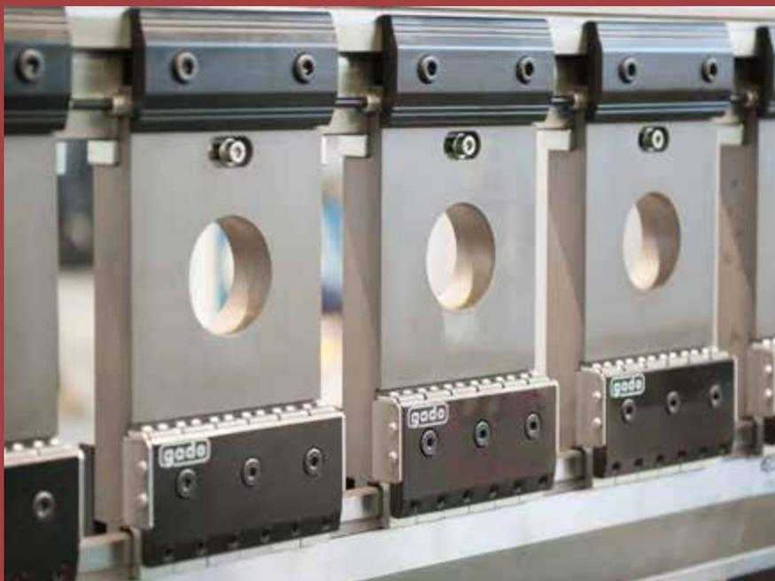
🇮🇹 Intermedio registrabile con altezza maggiorata (per scatolature profonde) con aggancio e sgancio frontale e bloccaggio pneumatico con autoallineamento.
