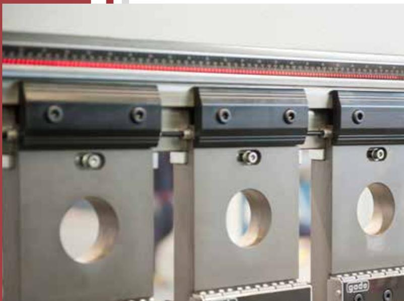
🇮🇹 Stringa led sul portalama superiore per facilitare l'operatore sia nell'attrezzaggio della piegatrice, sia nella piegatura con l'utilizzo di più stazioni.
