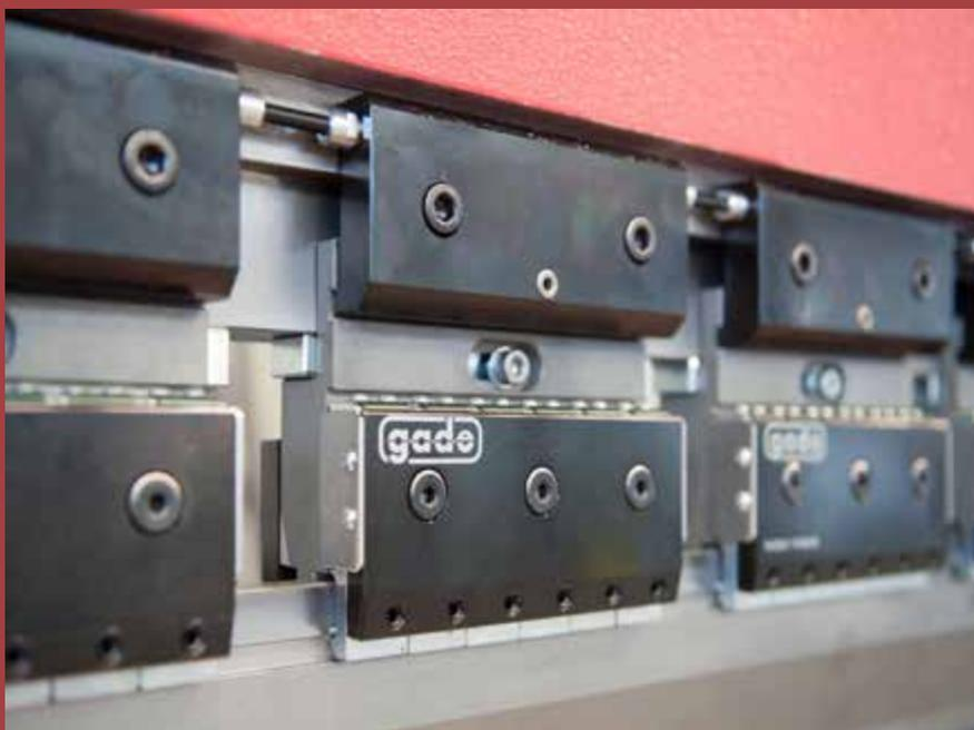
🇮🇹 Intermedio registrabile con aggancio e sgancio frontale e bloccaggio pneumatico con autoallineamento.
